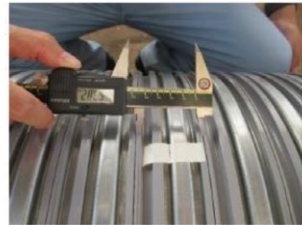
図.11 目開き量測定
