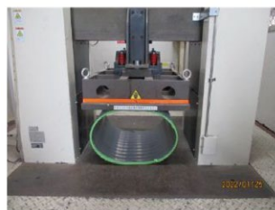
図 .7 偏平試験状況
