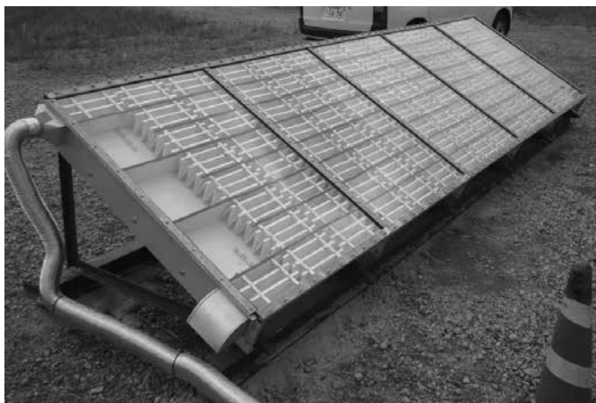
図8 MaSSC ソーラーリアクターの外観写真
