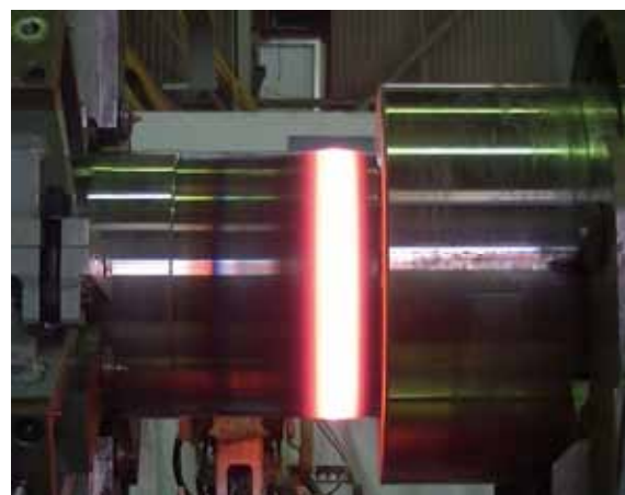
図3 φ340mmの摩擦圧接
