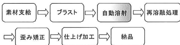
図1. スクリューの溶射工程
