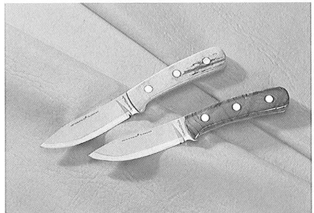
図8 D2 鋼の FSP により作られた刃物<sup>12)</sup>
