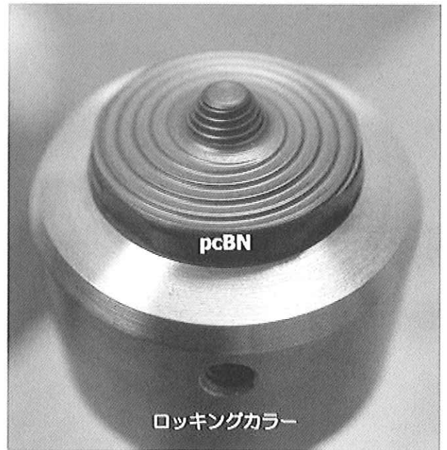
図3 pcBN (多結晶立方晶窒化ホウ素) ツール [CS4(Concave Scrolled Shoulder, Step Spiral)ピンツールの例] (MegaStir Technologies 社製)
