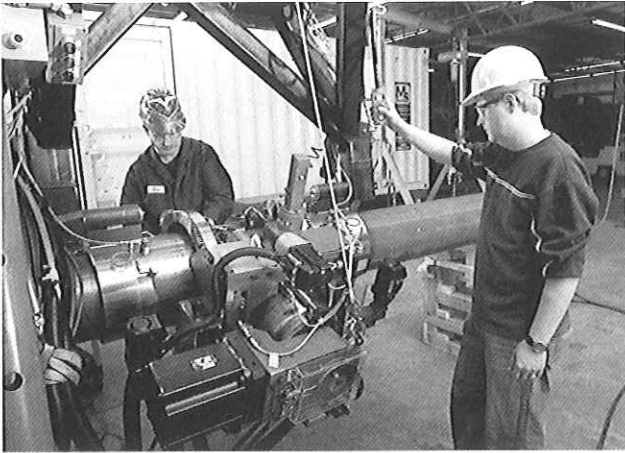
図5 パイプ用 FSW 装置 (MegaStir Technologies 社提供)
