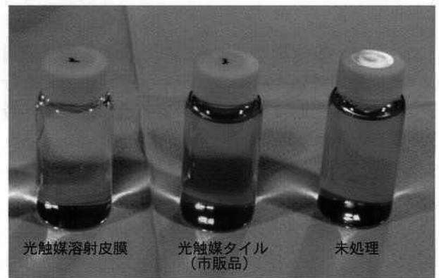
図-4 試験溶液(紫外線照射30時間経過後)
