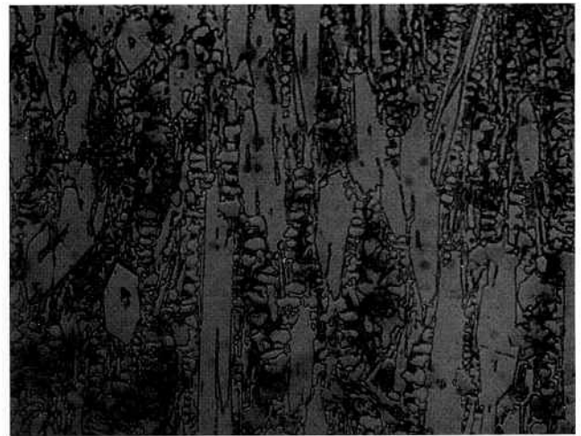
図-13 PLA-Tect 2のミクロ組織 (×400)
