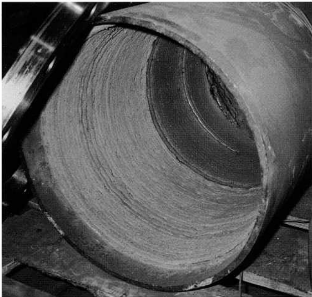
図-19 水砕ベンド管の製品内面
