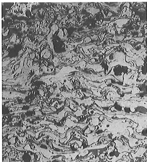
(1) アークワイヤー溶射 SUS420J2 100 \mu m
