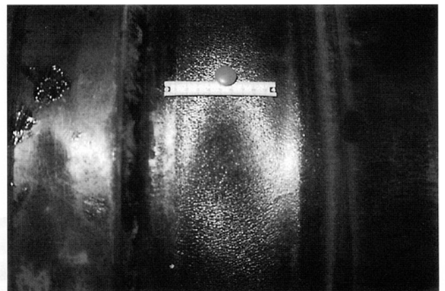
図-5 従来ロールの肌荒れ状況
