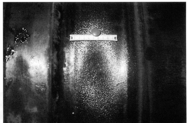
図-5 従来ロールの肌荒れ状況
