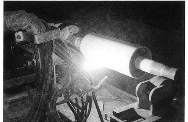
図-2 水プラズマ溶射写真
