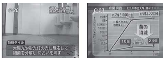
図 11 モノレールのトイレでの MaSSC シールドタイルの臭い抑制事例
